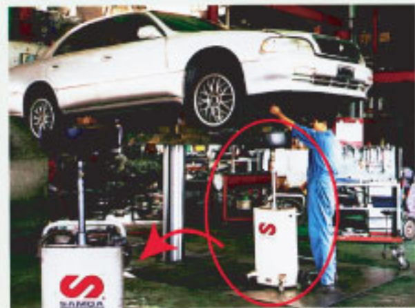
廃オイル回収作業
