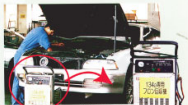
フロン回収作業
